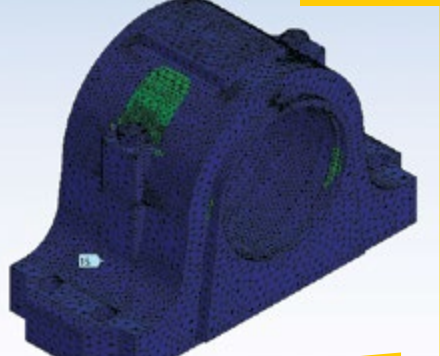
ضریب اطمینان پدستال تقویت شده در محل اتصال پایه ۱۵ می باشد
