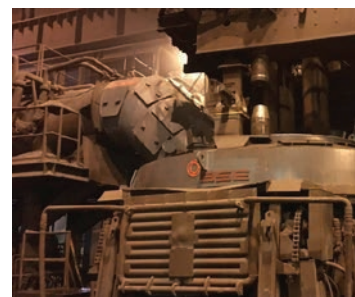
تصویر شماره ۲- استفاده از سیستم Spray-Cooling در سقف و زانوی کوره قوس الکتریکی شرکت Walsin Lihwa
