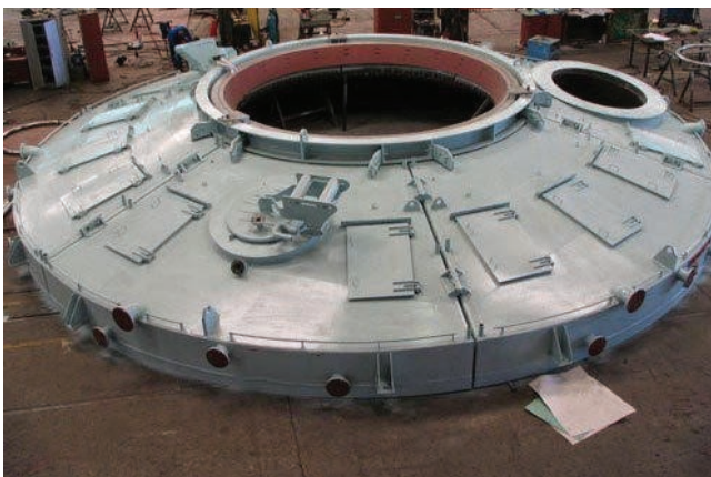
تصویر شماره ۳- نمونه سقف ساخته شده با تکنولوژی Spray-Cooling
